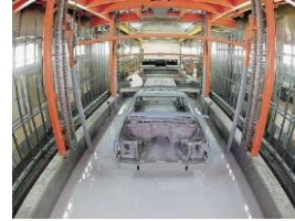
Nhúng Tĩnh Điện
